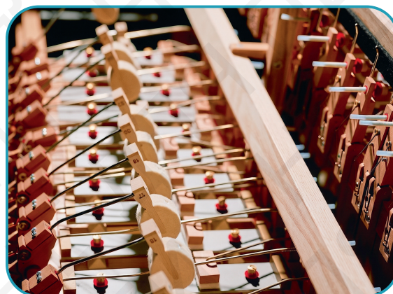
внутреннее устройство челесты
